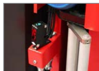
FOTOCPELLULA LETTURA PALLET PHOTOCCELL TO DETECT PALLET HEIGHT
