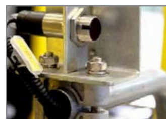
FOTOCELLE RILEVAMENTO PALLET PALLET DETECTION PHOTOCELLS
