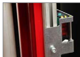
FOTOCCELLULA LETTURA PALLET PHOTOCCELL TO DETECT PALLET HEIGHT
