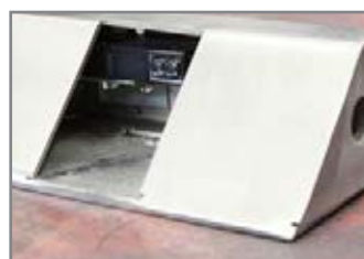
FOTOCELLULA SICUREZZA ENTRATA TRANSPALLET SAFETY PHOTOCELL PALLET ENTRY
