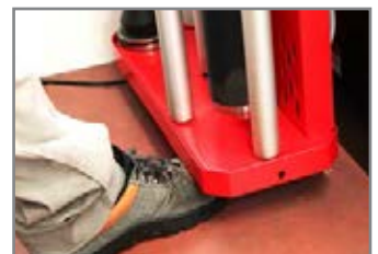
PROTEZIONE PARACADUTE CARRELLO SAFETY STOP DEVICE
