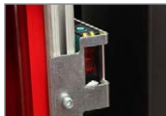
FOTOCPELLULA LETTURA PALLET PHOTOCELL TO DETECT PALLET HEIGHT
