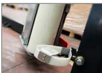
BUMPER DI ARRESTO MACCHINA SAFETY BUMPER
