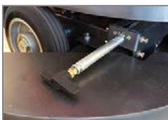
SISTEMA SBLOCCO DEL TIMONE HANDLE RELEASE SYSTEM
