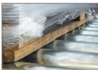
RULLIERA MOTORIZZATA TRASPORTO PALLET POWER RULLIER CONVEYOR
